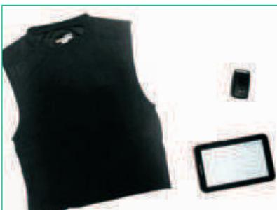
*FitnessSHIRT-System des Fraunhofer IIS (Shirt, Elektronik, Tablet) ■*
